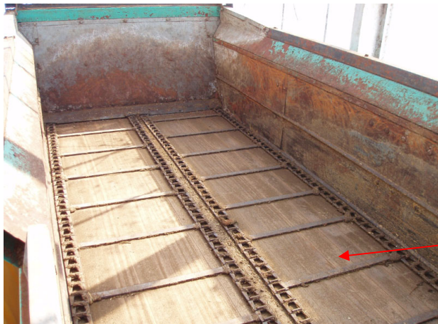
マニュアルスプレッダの台上面のコンベア (台の裏側でコンベアが凍結した)
