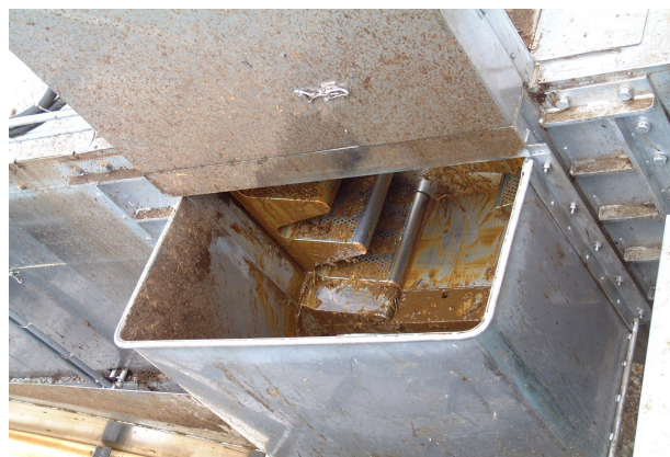
ウェービープレスのプレス装置内部
