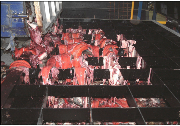
水産加工残滓を副資材破砕機の受入ホッパに投入した状況
