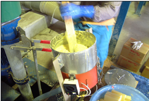
電熱ヒーターを利用して試作した溶解器。能率が悪く、少量であれば対応できるが、通常の利用には不適であった。
