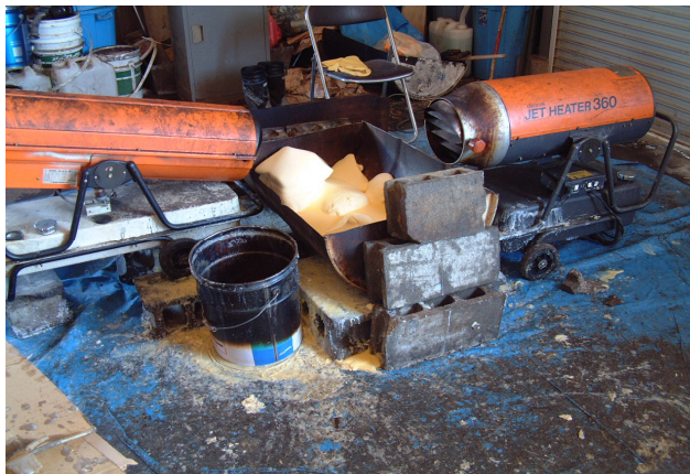
縦半割にしたドラム缶にバターを入れ、2台のジェットヒーターで溶解する方式。冬季はこの方式に落ち着いた。作業員2名が付きっきりで495kgの処理に14日間を要した。
