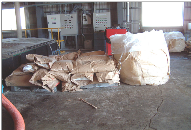
脱脂粉乳は25kg/袋で搬入される。綴じ口を切り開いて、ふん尿受入槽に投入する。粉塵となって舞い上がる。
