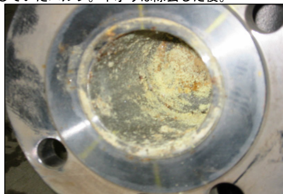
上写真：乾式脱硫塔の裏側の配管とバルブ群 左写真：乾式脱硫塔正面写真 下写真：閉塞していたバルブ。イオウは除去した後。
