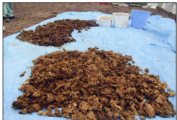
取り出した閉塞物
