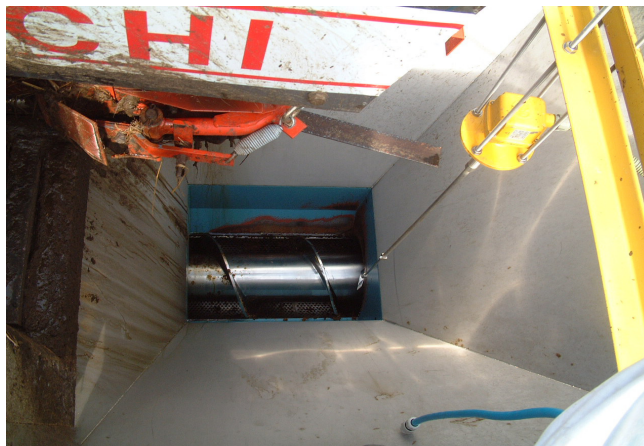
ホッパー部：内部にスクリーのシャフトと螺旋鏟が見える。右手の黄色の物体がセンサー
