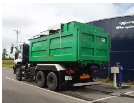
アームロール車 (コンテナ搭載時)
