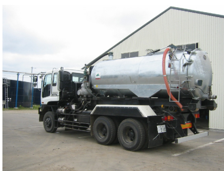
アームロール車 (バキュームタンク搭載時)
