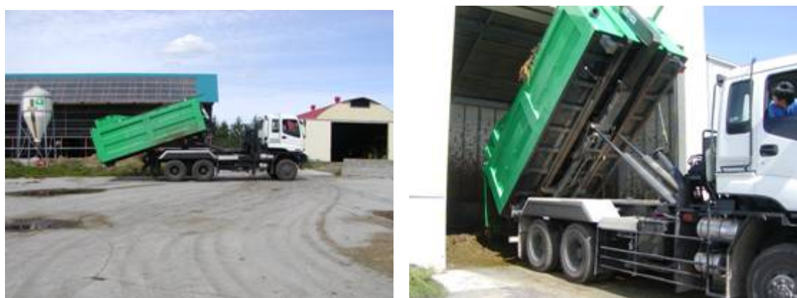
写真4 アームロール車によるコンテナの搭載状況（左）とプラントでの排出作業状況（右）
