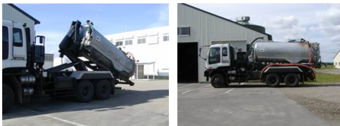
写真3 アームロール車の外観（右）と搭載時の状況（左）
