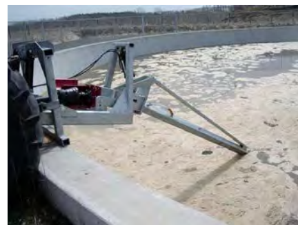
写真 1-2-8 プロペラ式攪拌方式による攪拌作業(トラクターPTO)
