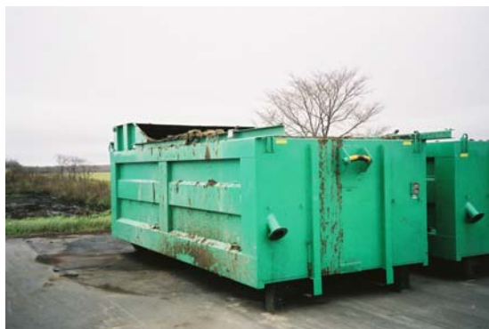
写真4-3-5 搬送用コンテナ
